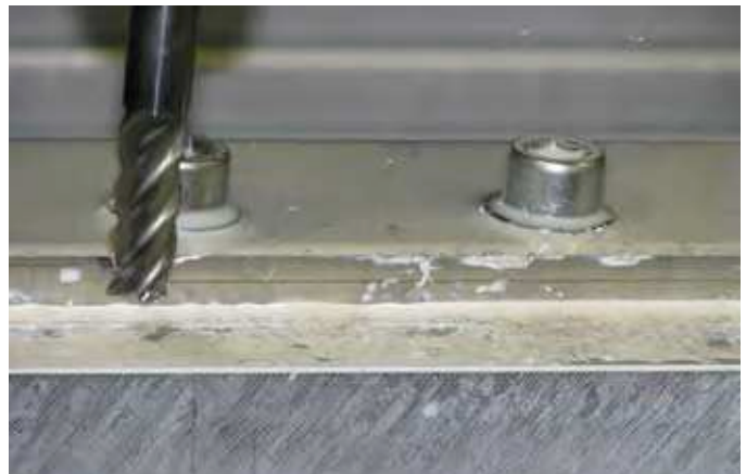
Da fliegen (kleine) Fetzen: Endkonturbearbeitung in einer Werkzeugmaschine bei ToolScope-Tests
